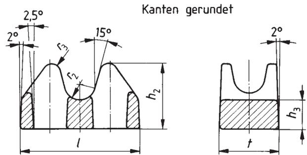
Bezeichnung einer vollständigen Drahtseilklemme S, von Nenngröße 22, bestehend aus Klemmbügel (SA), Klemmbacke (SB) und zwei Bundmutter (SC):
