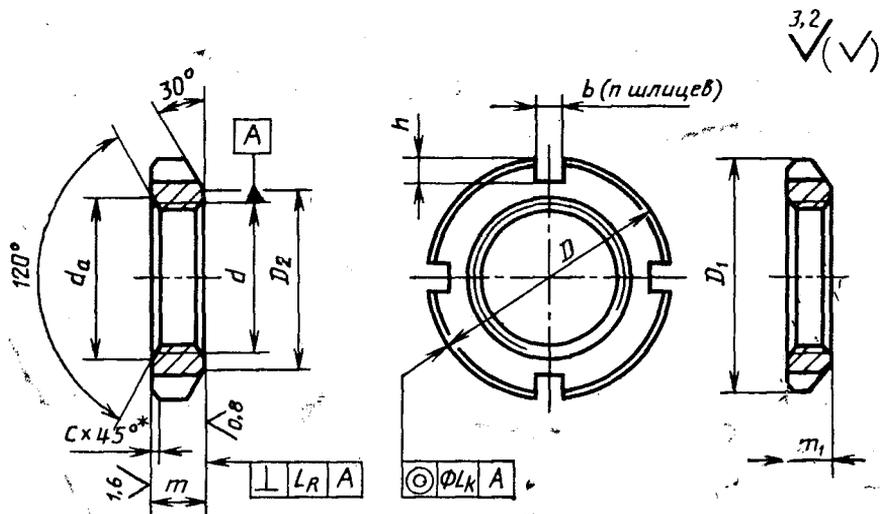
\* Допускается вместо фаски скругление радиусом  $R=c$  и отсутствие фаски для исполнения 2.
